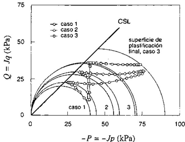
Figura 18. Cálculos en pequeñas deformaciones: trayectorias de tensiones efectivas de Kirchhoff para el punto  $B$  de Gauss mostrando el crecimiento de la superficie de plastificación durante la carga sin drenaje (caso 1: sin precarga; caso 2: con 15 kPa de precarga; caso 3: con 30 kPa de precarga); CSL - línea de estado crítico
