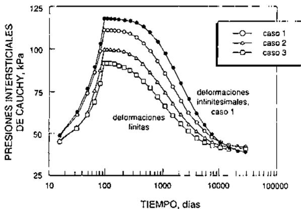
Figura 16. Consolidación hiperelástica con deformaciones finitas: presión intersticial de Cauchy en el punto  $B$  en función del tiempo (caso 1: sin precarga; caso 2: con 15 kPa de precarga; caso 3: con 30 kPa de precarga)
