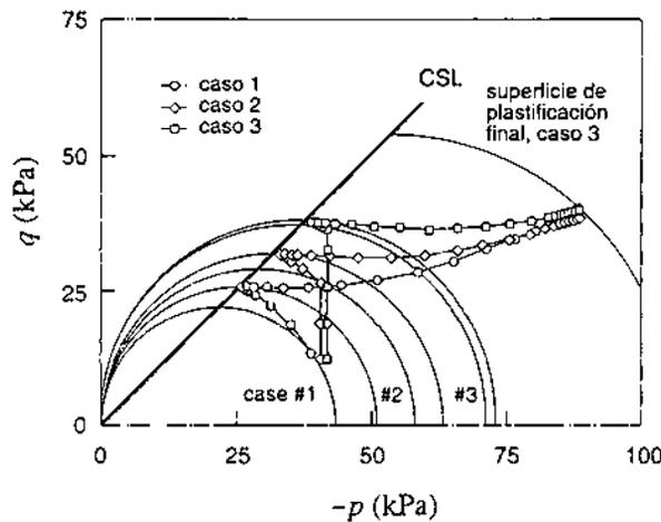
Figura 17. Cálculos en pequeñas deformaciones: trayectorias de tensiones efectivas de Cauchy para el punto  $B$  de Gauss mostrando el crecimiento de la superficie de plastificación durante la carga sin drenaje (caso 1: sin precarga; caso 2: con 15 kPa de precarga; caso 3: con 30 kPa de precarga); CSL - línea de estado crítico
