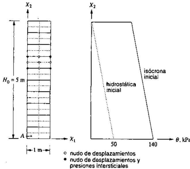
Figura 1. Malla de elementos finitos y presiones iniciales en el agua intersticial para el problema de consolidación monodimensional
