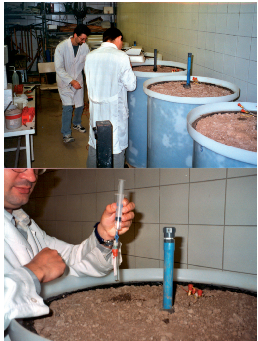
FIGURA 2. Assaig de factibilitat amb lisímetres per avaluar el subministrament d'aire, humitat òptima i addició de nutrients en un sòl contaminat d'olis minerals (Clipper Oil, Lliçà de Vall).
