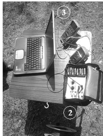
**Figura 3:** Mecánica de registro de la resistividad eléctrica del subsuelo: (1) dispositivo móvil de electrodos, (2) fuente de corriente alterna y (3) adquisición automática de datos
