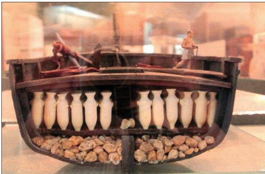
Fig. 12. Representación idealizada de un barco mercante cartaginés (gaulós). Se caracteriza por su alto cobotaje. Popa y proa están levantadas. Su fuerza motriz dependía de sus velas, tenían una gran capacidad y podían alcanzar una velocidad de cinco nudos. Museo de Arqueología e Historia de Melilla.
