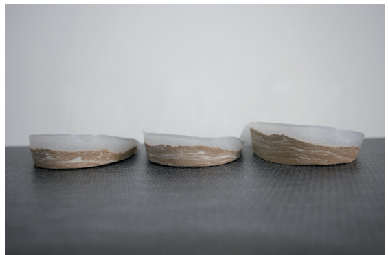
Figura 4. Posteos de retropié derecho: 3, 6 y 9 mm de altura a nivel medial, de izquierda a derecha respectivamente.
