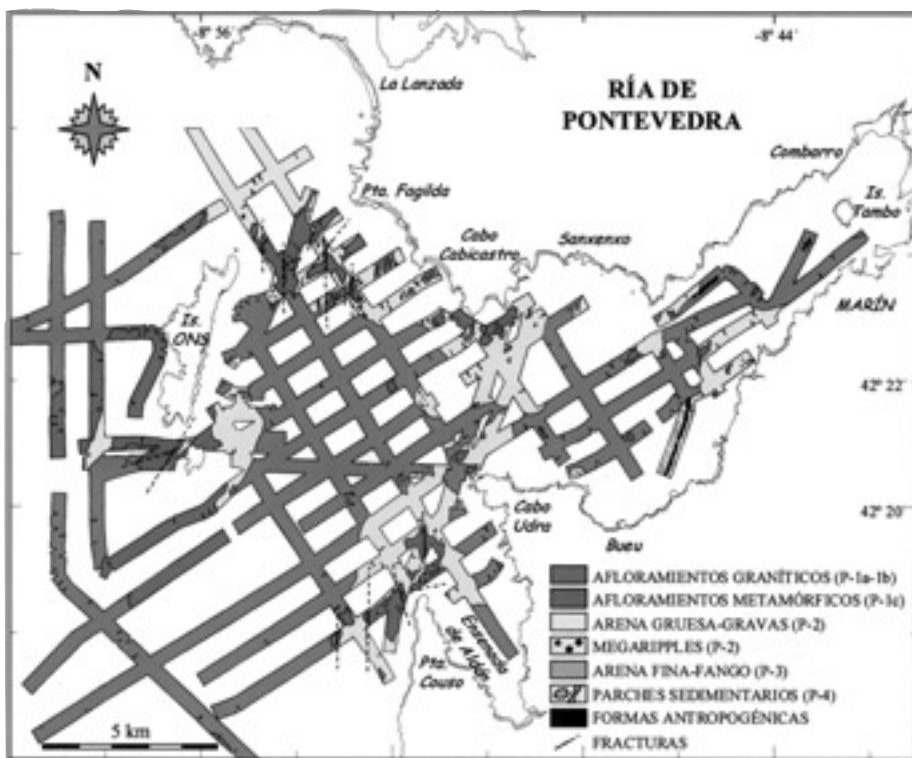
FIG. 13.—Cartografía de alta resolución del fondo de la Ría de Pontevedra elaborada a partir de los registros de sonar de barrido lateral, muestras de fondo y geología de superficie (Modificado de García-Gil et al. , 2000).
