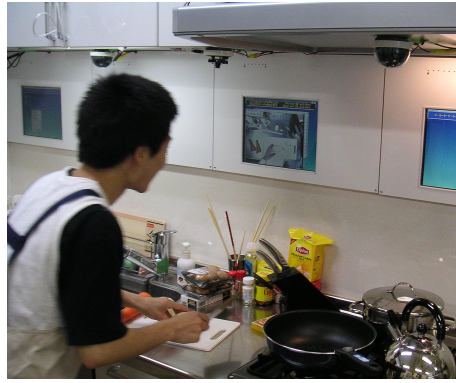
図5 記録した調理過程を再生し、調理を行っている様子。フットスイッチの操作で、次の手順の写真に切り替わる。
