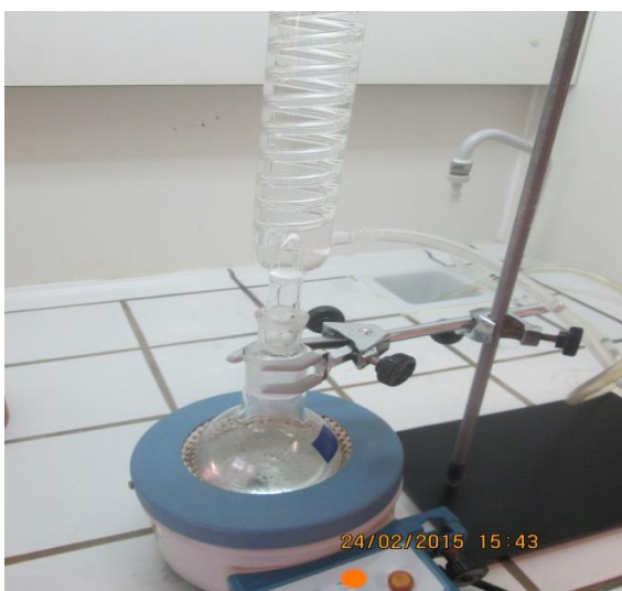
Figura16 - Manta de aquecimento e condensador
