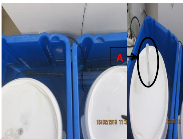
Figura 6 - Fermentadores com Termóstato em banho Maria. A - Armadilha de ar.
