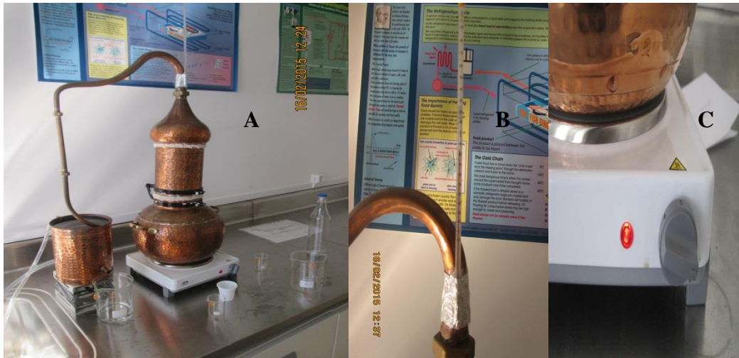
Figura 11 - A - Alambique, B - termómetro para controlar a temperatura e C - placa de aquecimento
