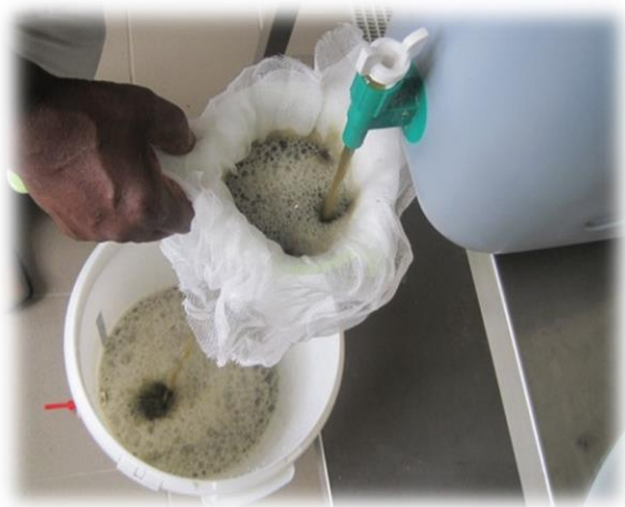
Figura 5 – Filtração das impurezas do caldo através do funil com gaze
