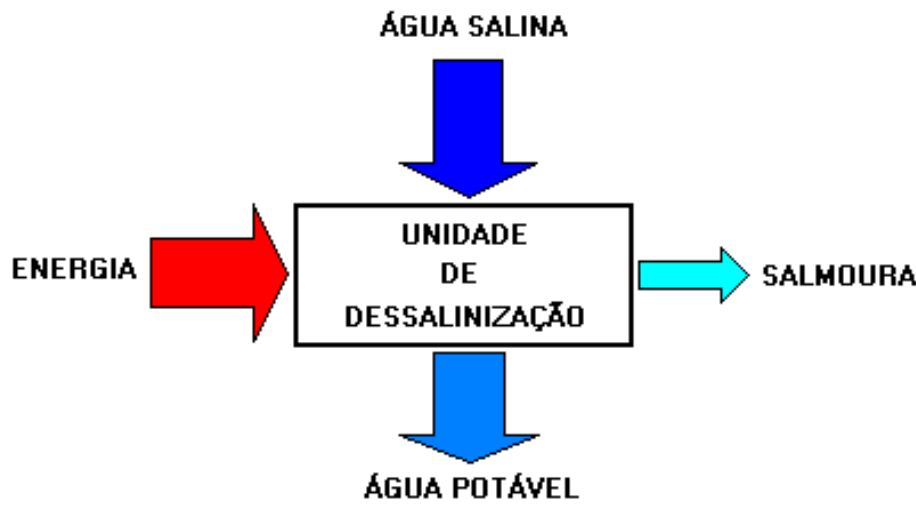
Fig. 5.2: Esquema simplificado de uma unidade de dessalinização.
