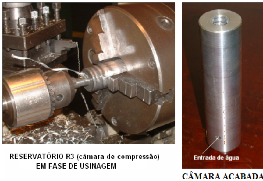
Fig. 3.22: Usinagem da câmara de compressão e câmara acabada.
