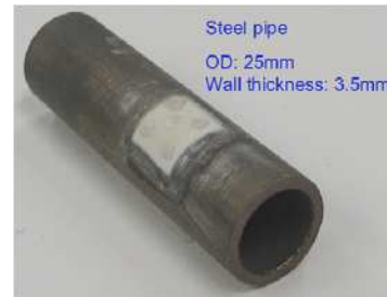
Figure 4. A FUT brazed onto a steel pipe.
