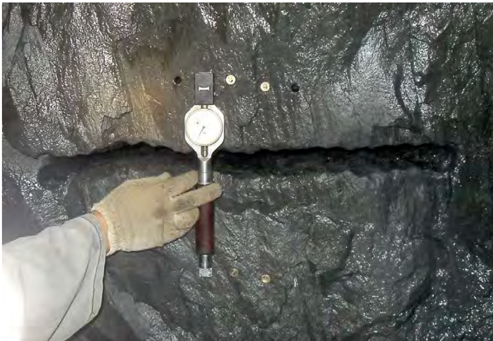
Рис. 3. Замер баз после разгрузки горизонтальной щелью
