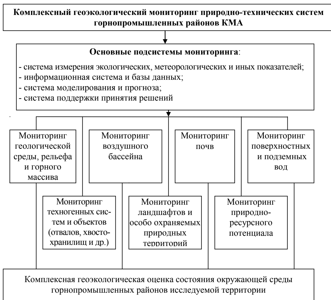
Рис. 1. Структурная схема комплексного геоэкологического мониторинга природно-технических систем территории горнопромышленных районов
