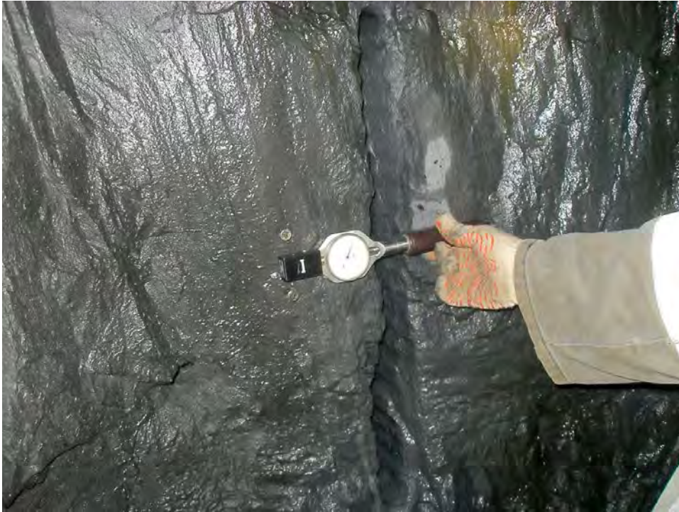
Рис. 2. Замер баз после разгрузки массива вертикальной щелью
