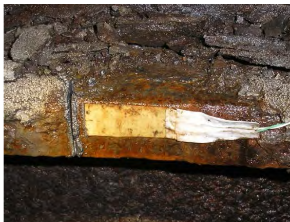
Рис. 2. Фото ребра чугунного тубинга с тензорезистором после применения метода частичной разгрузки
