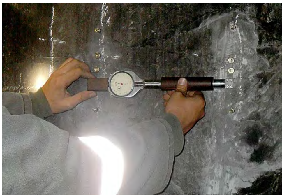
Рис. 1. Замер баз до разгрузки массива
