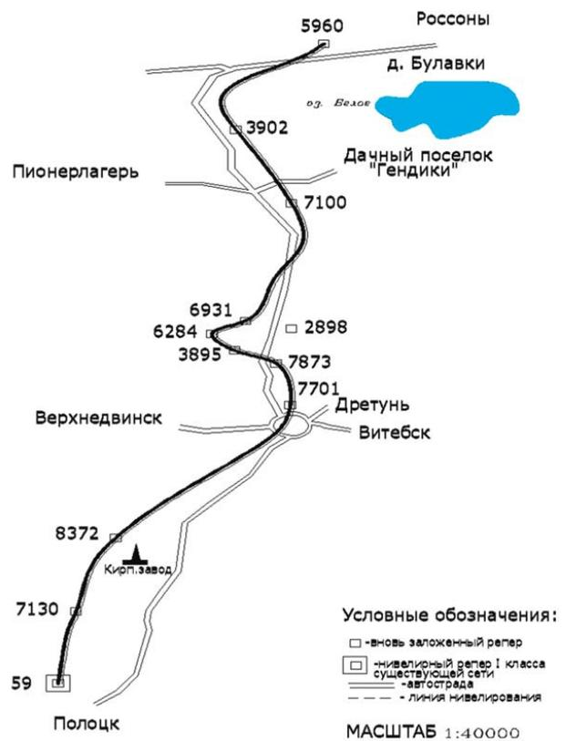
Рисунок 9.11 – Схема расположения пунктов Полоцкого геодинимического микрополигона
