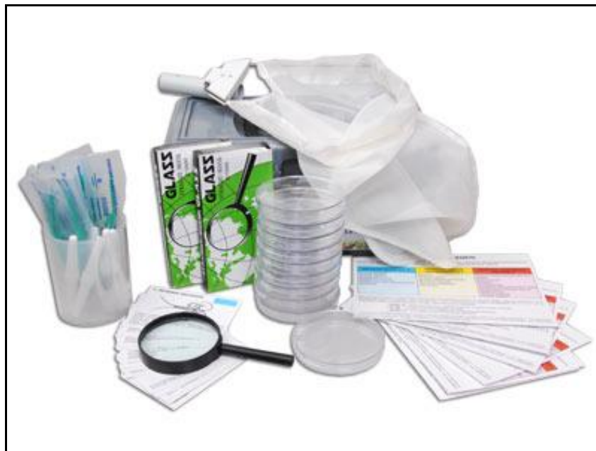
Рис. 5 . Набор для исследования экологического состояния водоема методом биоиндикации
