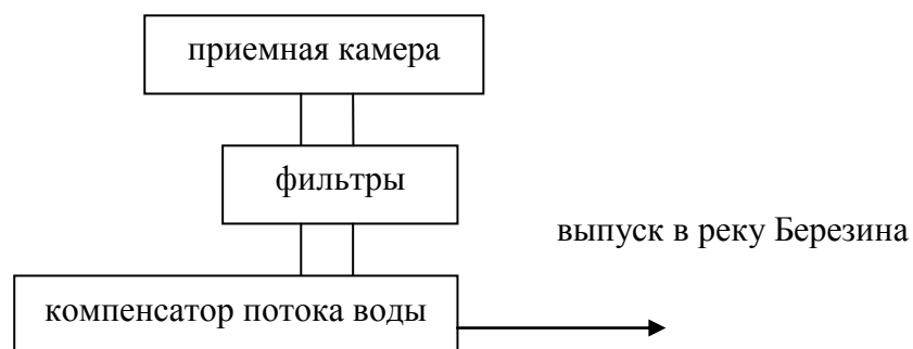
Рис. 55. Ливневые очистные сооружения УП «Жилье» (выпуск в р. Березина на дороге Р-53 Слобода-Новоселы) [16]
