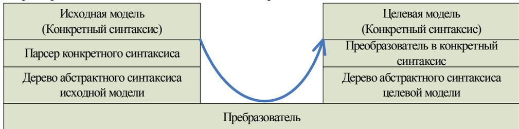
Рис. 1.4. Схема преобразования модели системы
