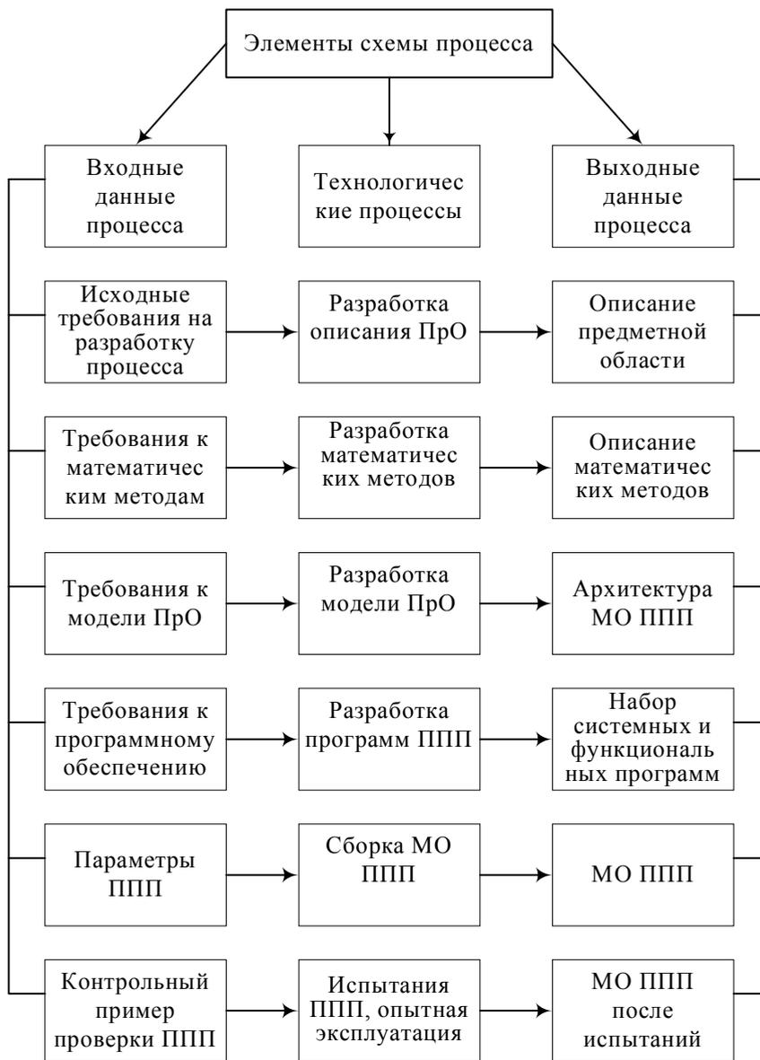
Рис.8.9. Схема процесса разработки методо-ориентированных PPP
