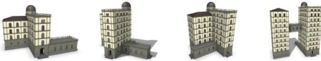
Εικόνα 6.4: Εφαρμογή των κανόνων γραμματικής CGA (πηγή: Muller et al, 2006)
