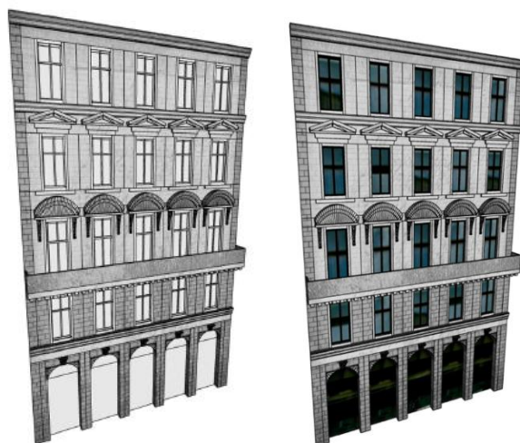
Εικόνα 7.8: Το αποτέλεσμα της μοντελοποίησης με τη χρήση του Façade Wizard (Muller et al, 2006)
