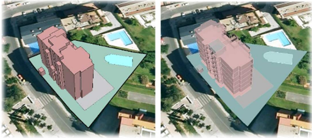
Εικόνα 3.13: (αριστερά) Μοντέλο κτηρίου με εξώθηση του όγκου (δεξιά) Μοντέλο κτηρίου με παραγωγή των ανεξάρτητων μονάδων (πηγή: Garcia et al, 2011)
