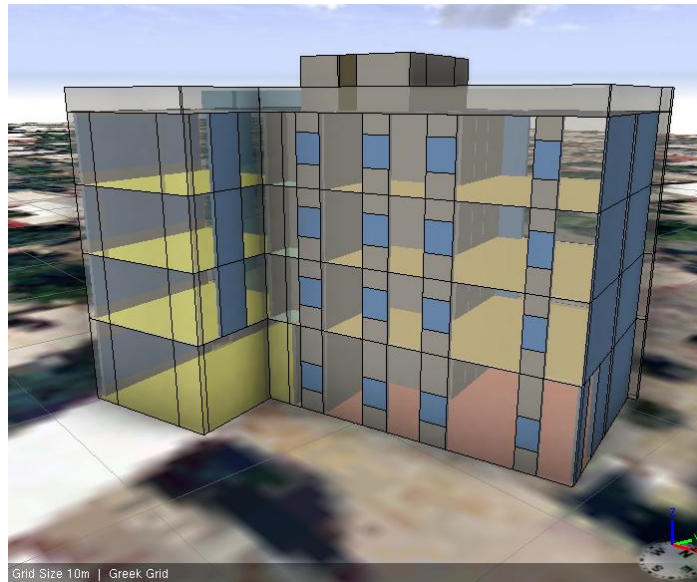
Εικόνα 8.17: Τρισδιάστατο μοντέλο κτηρίου μετά την αποσύνθεσή του στα κτηριακά μέρη και ταυτόχρονη απεικόνιση των διαφορετικών χρήσεων με διαφορετικό χρώμα
