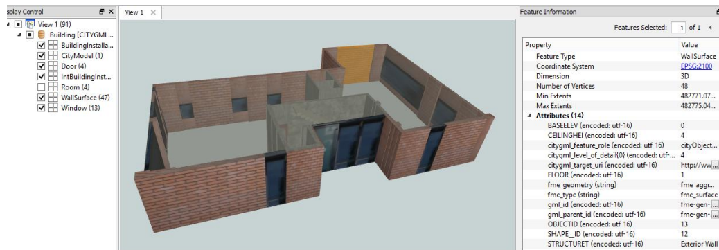
Εικόνα 8.26: Το τελικό CityGML αρχείο εντός του FME Data Inspector
