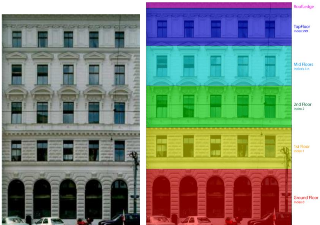
Εικόνα 7.5: Πρόσοψη κτηρίου (αριστερά), Διάσπαση της προσόψεως του κτηρίου κατά τον οριζόντιο άξονα (δεξιά), (Πηγή: Muller et al, 2006)
