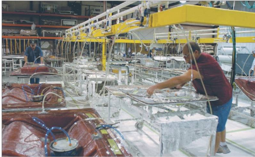
Pienosien valmistusta Light RTM menetelmällä (Kuva Professional boatbuilder no 113, Cobalt Boats)
