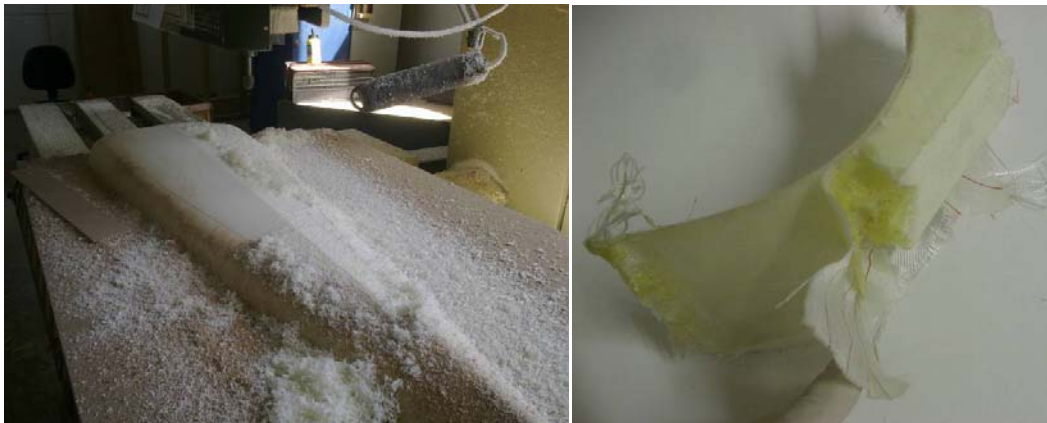
Lestikappaleen jrsintää KymiDesignin vanhalla jrsimellä ja testipala, josta vaahto on sulatettu asetonilla (kuvat Mikko Pitkäaho)
