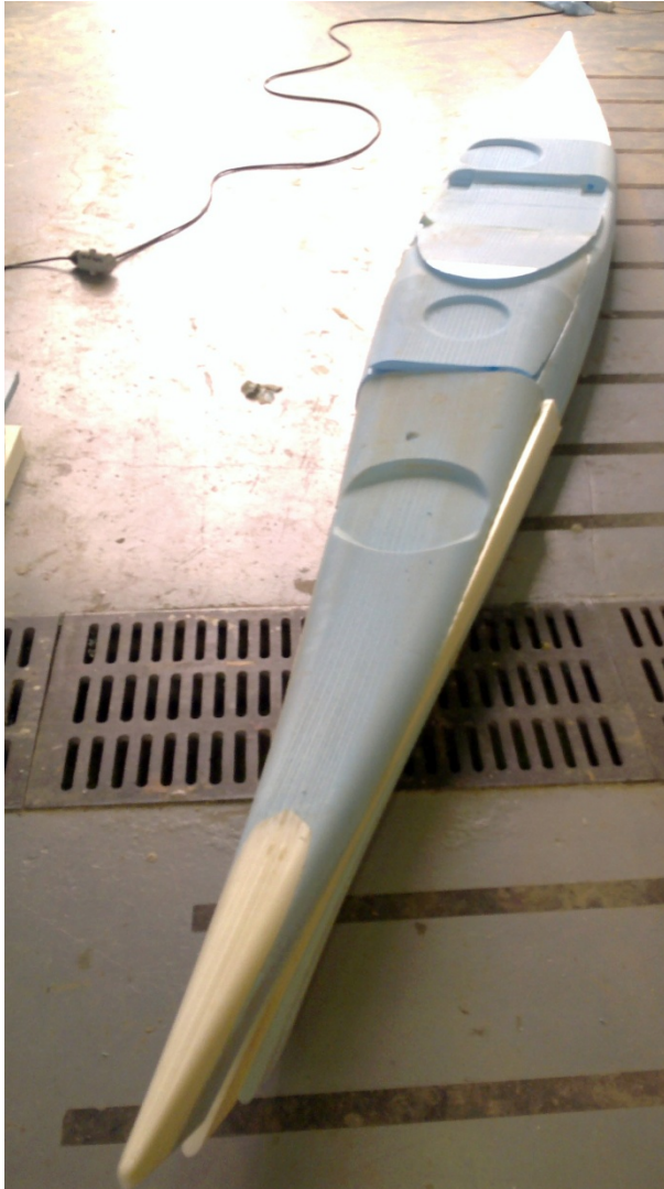
Kajakin proton lestikappale jyrstittynä, (kuva Ari Haapanen)
