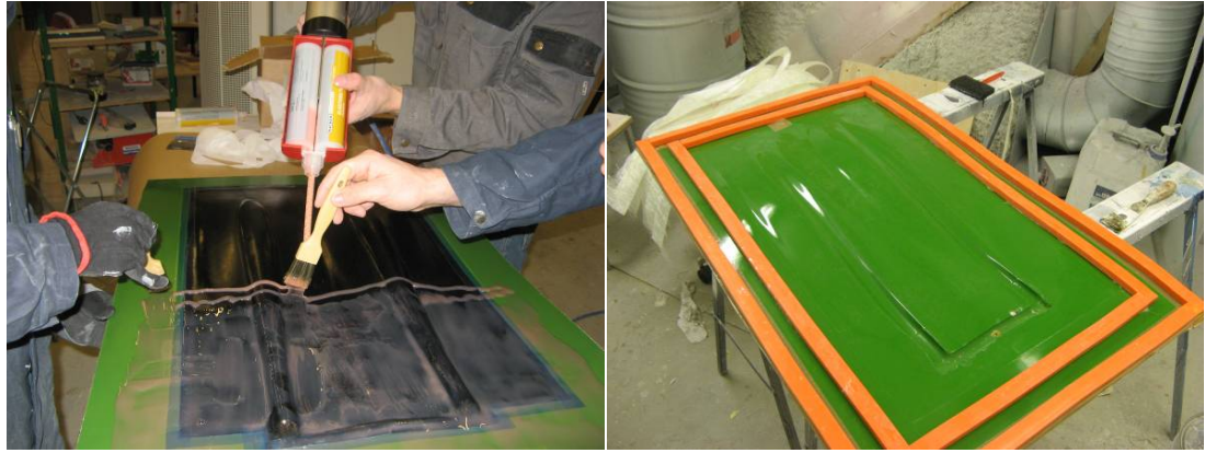
Silikoni kuorimuotin ja tiivistekauluksen valmistustamelan muottia varten(kuva Mikko Pitkäaho)
