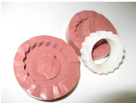
Pikamallinnettu hammaspyörä ja siitä tehty silikonimuotti(kuva Mikko Pitkäaho)
