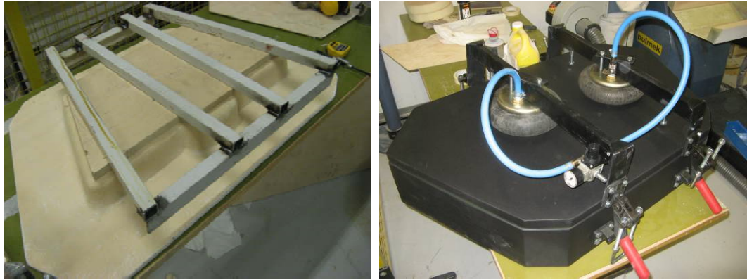
Muotin tuennan rakentaminen ja valmis muotti LPCM kokeiluun (kuvat Mikko Pitkäaho)
