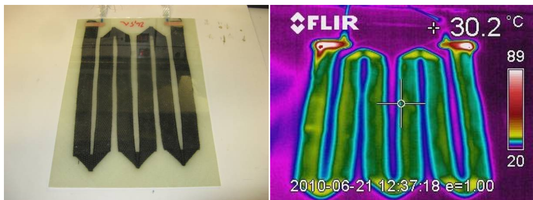
Hiilikuidulla toteutettu paneeli, huono liitos hiilikuituun kuumenee, (kuvat Mikko Pitkäaho)
