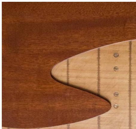
CUTTS-menetelmällä toteutettua veneenkylkeä, (kuva RedSkyCraft Oy)
