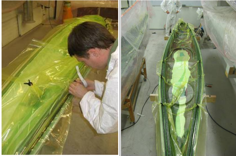
Kajakin injektointia Kyamk komposiittilaboratoriolla, (kuvat Mikko Pitkäaho)
