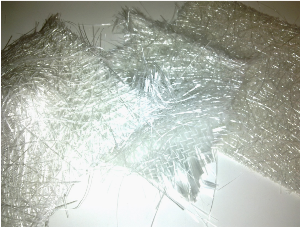
Suljetunmuotin menetelmää varten kehitettyjä lujitteita. (kuva Mikko Pitkäaho)
