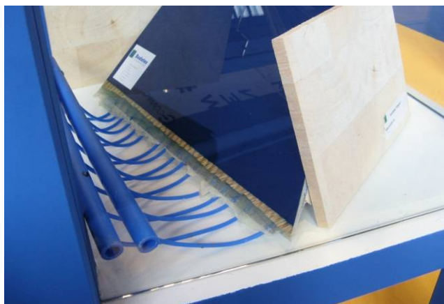
Vesikiertoinen muotinvärmitys putkituksella toteutettuna (kuva JEC 209 Mikko Pitkäaho)
