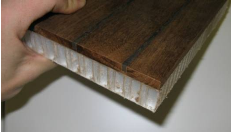
Vesilasikyllästettyä koivua Nidacore kerroslevyn päällä, (kuva Mikko Pitkäaho)
