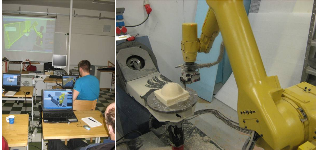
Robotin off-line ohjelmointia ja jyritys koekappale(kuvat Mikko Pitkäaho)
