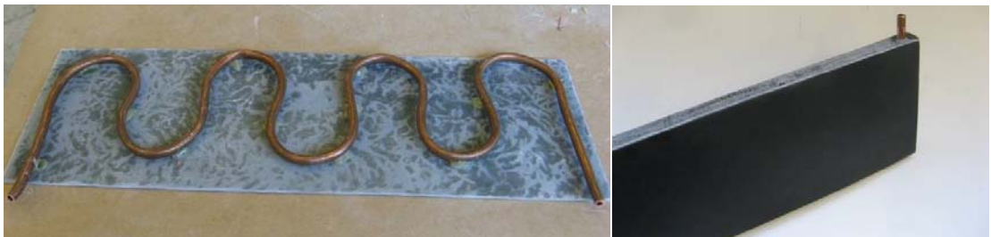
Kupariputkesta taivuteltu lämmityspotkisto(kuva Mikko Pitkäaho)
