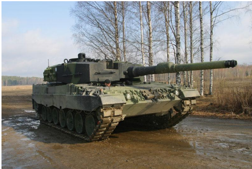
KUVA 9 Leopard 2 A4 panssarivaunu jossa käytetään kumilappuja. (Puolustusvoimat. n.d.)
