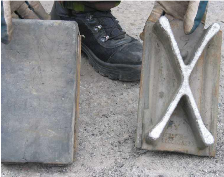
KUVA 8 Kuvassa vasemmalla kumilappu ja oikealla talvitassu, jolla ei saa ajaa tieverkolla. (Puolustusvoimat. n.d.)
