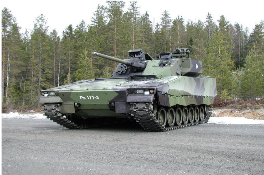
KUVA 10 CV9030 rynnäköpanssarivaunu jossa on asennettuna kumilaput. (Puolustusvoimat. n.d.)
