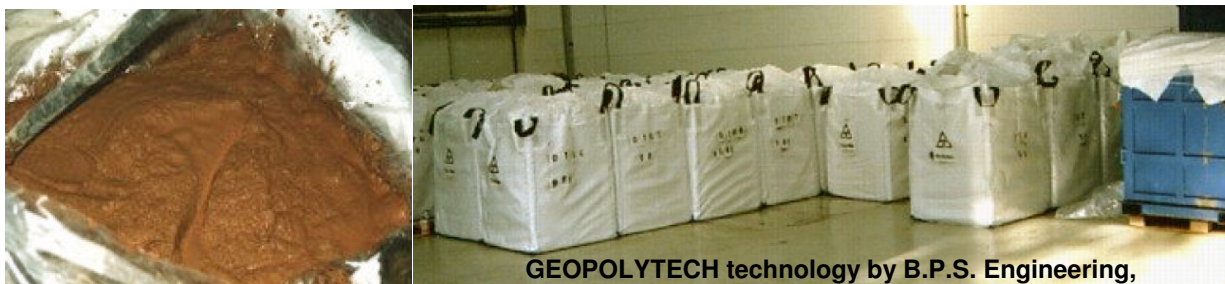
Figura 5. Geopolimero miscelato con le scorie tossiche e sito di stoccaggio [8, 11, 16].
