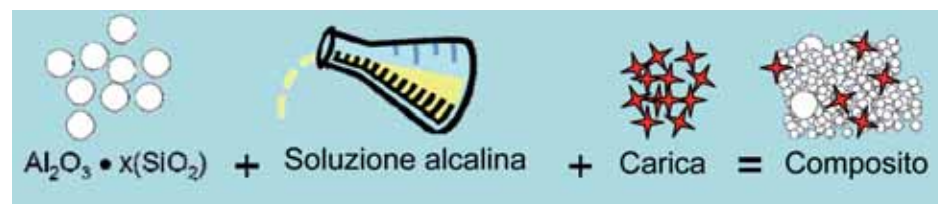
Fig. 1 - Rappresentazione schematica della preparazione dei geopolimeri compositi.
