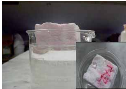
Fig. 6 - Pannello ultraleggero impermeabilizzato con idrorepellenti commerciali.
