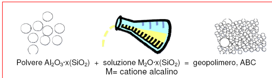
FIGURA 1: Schema di preparazione di un geopolimeri a partire da alluminosilicato, Al_2O_3 \cdot x(SiO_2) miscelato con soluzione alcalina, M_2O \cdot x(SiO_2) per ottenere un geopolimero (6).
