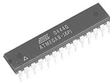
Figura 3. Il cuore della scheda elettronica, un ATMEGA8-16PI prodotto dalla Atmel .
