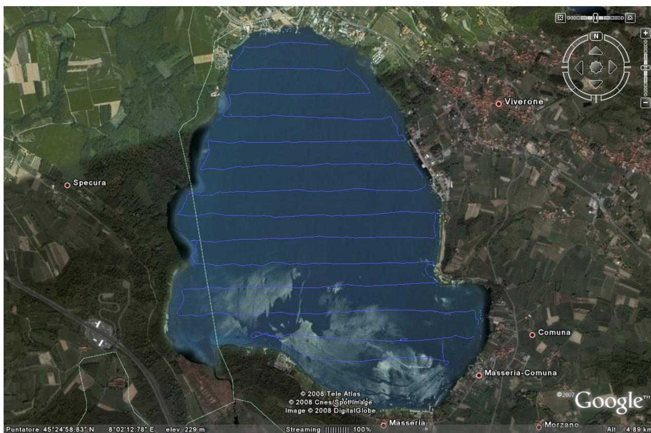
Fig. 26. Percorso dell'imbarcazione per il monitoraggio della fauna ittica mediante il sistema idroacustico
