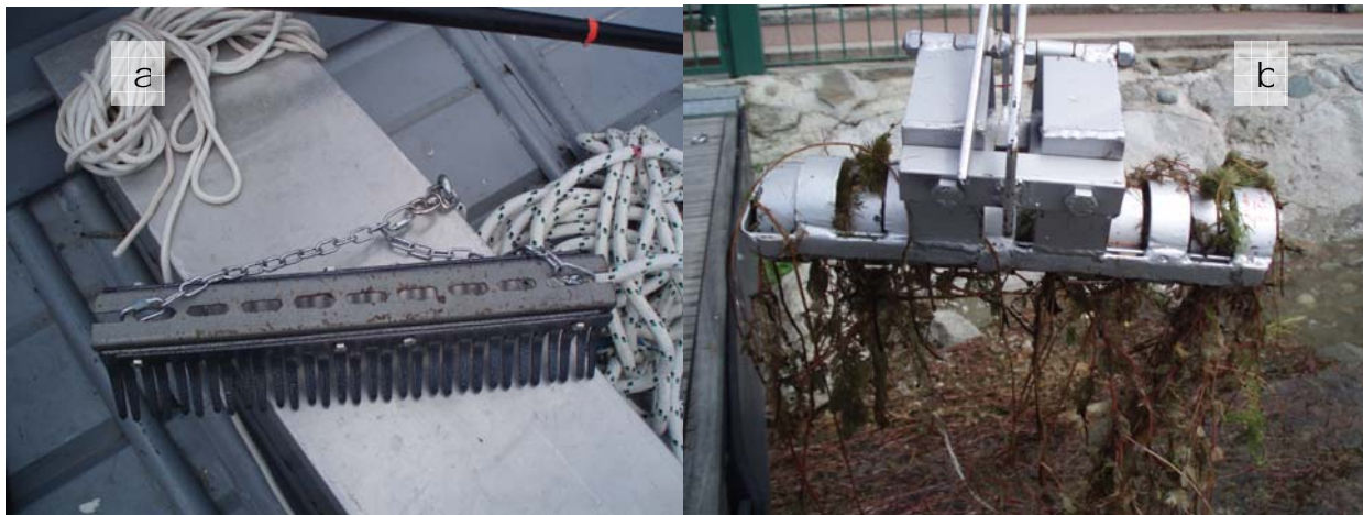
Fig. 13. Rastrello (a) e draga di Ponar modificata (b).
