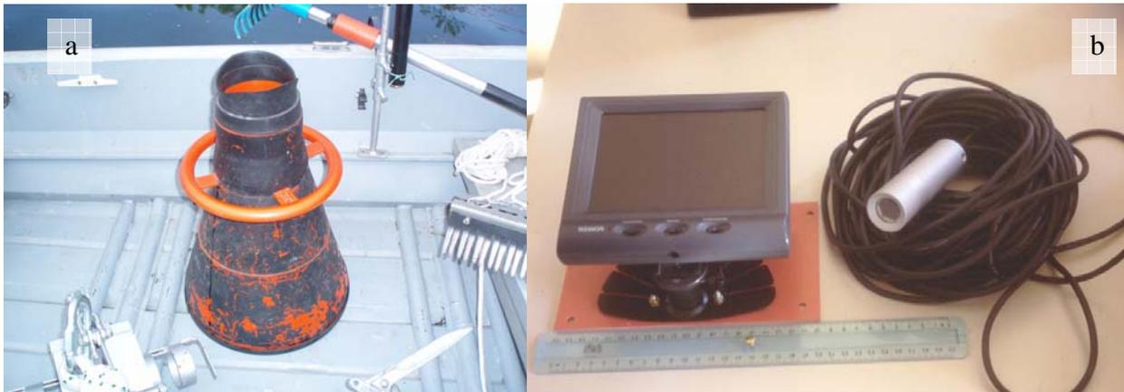
**Fig. 13.** Batiscopio (a) e kit telecamera subacquea (b).
