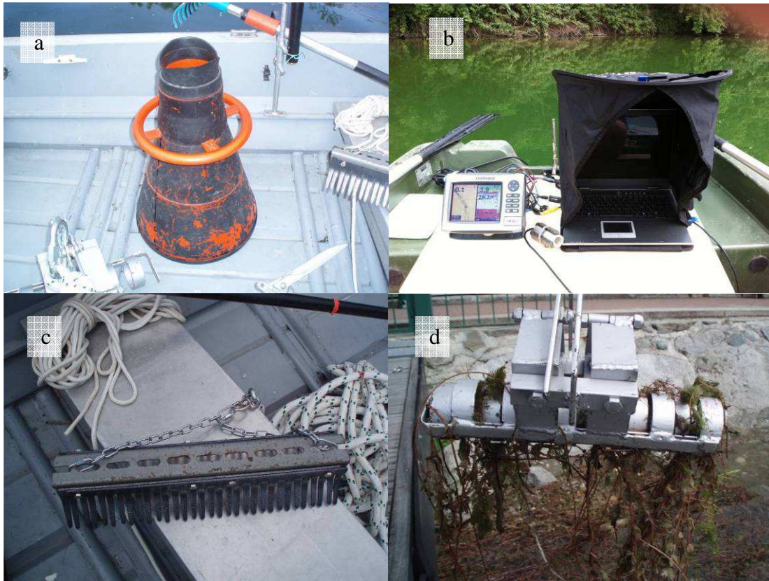
Figura 1.3.7 - Alcuni strumenti per il campionamento macrofitico. Batiscopio (a), kit telecamera subacquea e ecoscandaglio collegati ad un sistema GPS e al computer (b), Rastrello (c) e draga di Ponar modificata (d).
