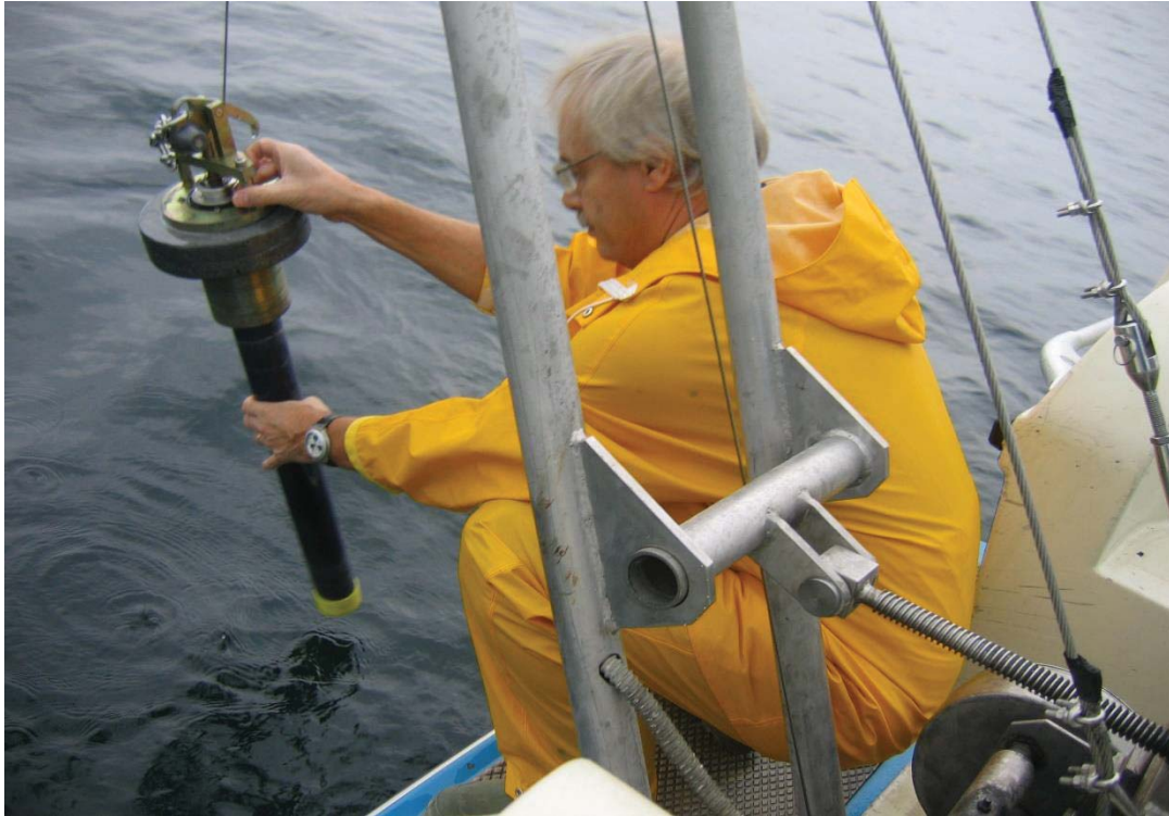
Fig. 5.1.2. Prelievo di sedimento lacustre mediante carotatore a gravità.
