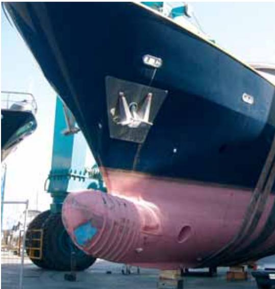
Foto 9 - Installazione del tunnel dell'elica di prua, senza alcun accorgimento, su uno yacht di oltre 30 metri: non ci sono avviamenti in prossimità del tunnel e sul bulbo sono stati saldati dei profilati sporgenti contrari a ogni principio di idrodinamica.
