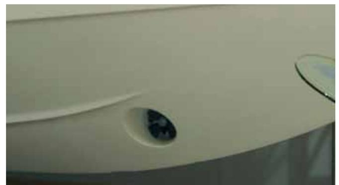
Foto 3 - Tunnel realizzato senza nessun avviamento. In questo caso, l’acqua che risale dal basso e da prua va ad impattare contro la parete interna del tunnel.
