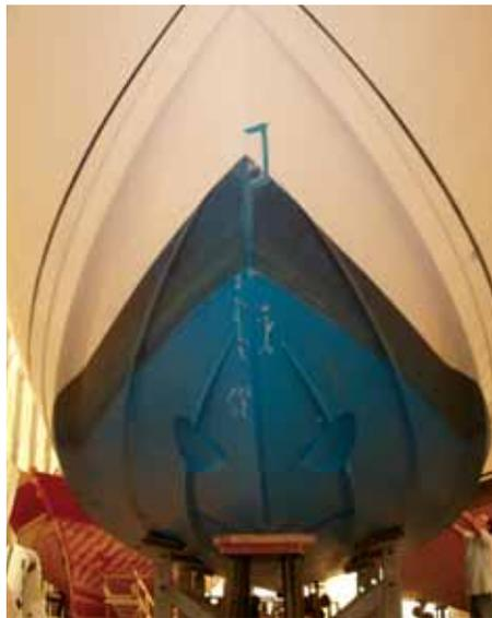
Foto 10 - "Unghiature" realizzate su scafi plananti: sono meno opportune perché nell'impatto verticale con l'onda l'acqua non viene aiutata a sfuggire via, ma viene trattenuta dall'unghiatura che si comporta come fosse un cucchiaio.
