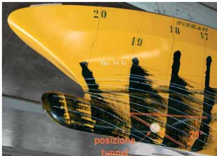
sulla parete interna del ringrosso/tunnel. Nella foto 3 invece il tunnel è stato costruito senza realizzare nessun avviamento: è facile immaginare l'acqua che, risalendo dal basso e da prua, va a impattare contro la parete interna del tunnel.
