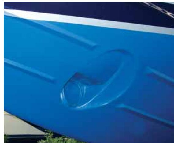
Foto 13 - Cosa non fare: nessun ringrosso a monte del tunnel e, a valle, l'unghiatura poco estesa longitudinalmente e quindi inutile. Concavità che si estende ben al di sopra del tunnel ed è molto profonda. Risultato una sorta di enorme cucchiaio che raccoglie e trattiene l'acqua proveniente dal basso e da davanti. Sarebbe stato meglio realizzare solamente il tunnel.
