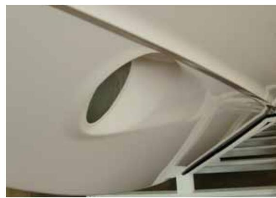
Foto 11 - Soluzione ibrida su uno scafo planante. Sono presenti sia l'unghiatura a poppa del tunnel che il ringrosso a monte: può funzionare, a patto che sia pensata e progettata con cognizione di causa.
