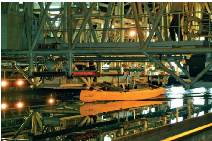
Uno degli oltre 50 modelli di Luna Rossa in scala 1 a 3 provati per all'Insean
