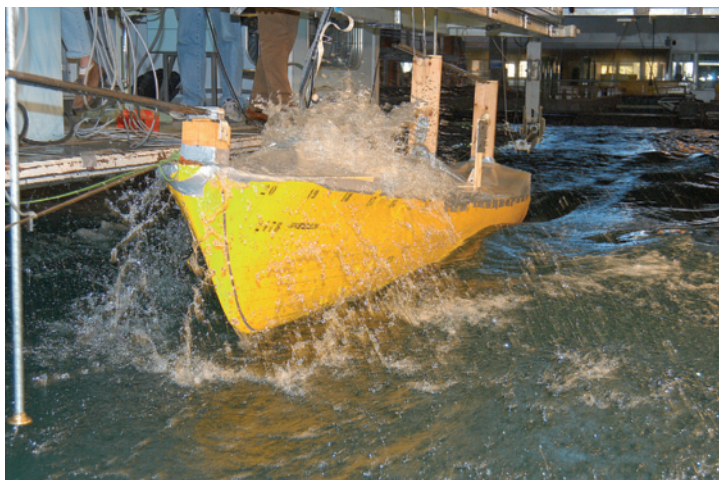
Prove di seakeeping (tenuta al mare) eseguite al bacino N.2 dell'Insean (220 x 9 x 3,5 metri) su un modello di corvetta militare in scala 12 alla corrispondente velocità di 18 nodi e mare di prua forza 5
