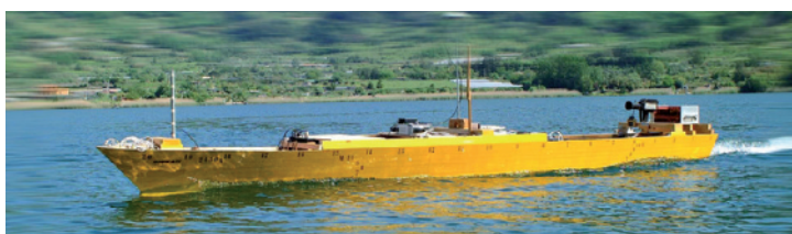
Prove di manovrabilità con modello radiocomandato e autopropulso al lago di Nemi
