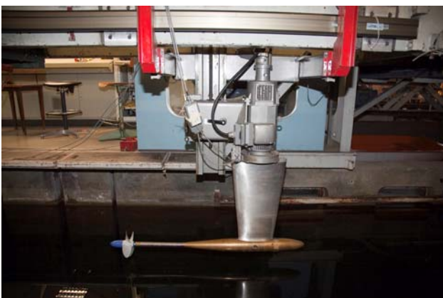
Figura 2: la bilancia H29 della Kempf & Remmers GMBH di Amburgo
