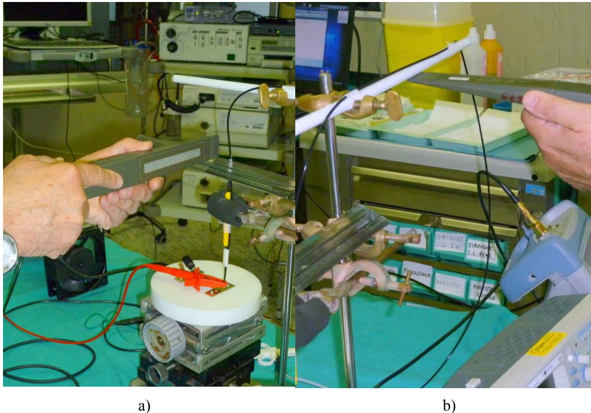
Fig. 5 – Misure del campo magnetico con la sonda hp 11941A: (a) in punti equidistanti fra loro 1 cm lungo la linea perpendicolare al manipolo; (b) ad 1.2 cm di distanza dal cavo.
