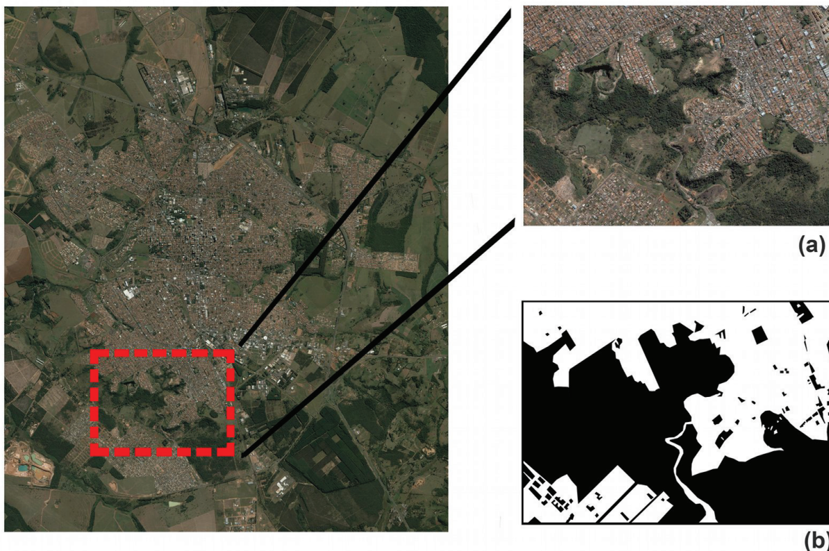
Figura 4: Mapa da cidade de São Carlos e o recorte de uma determinada região (a), com o processamento de áreas edificadas e não-edificadas realizados por especialista (b).
