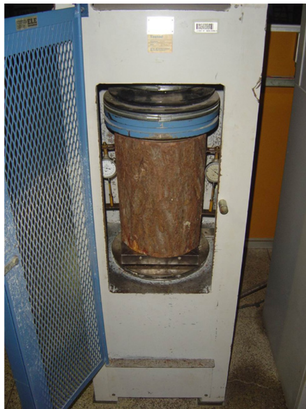
Figura 2. Ensaio de compressão paralela em elemento estrutural roliço
