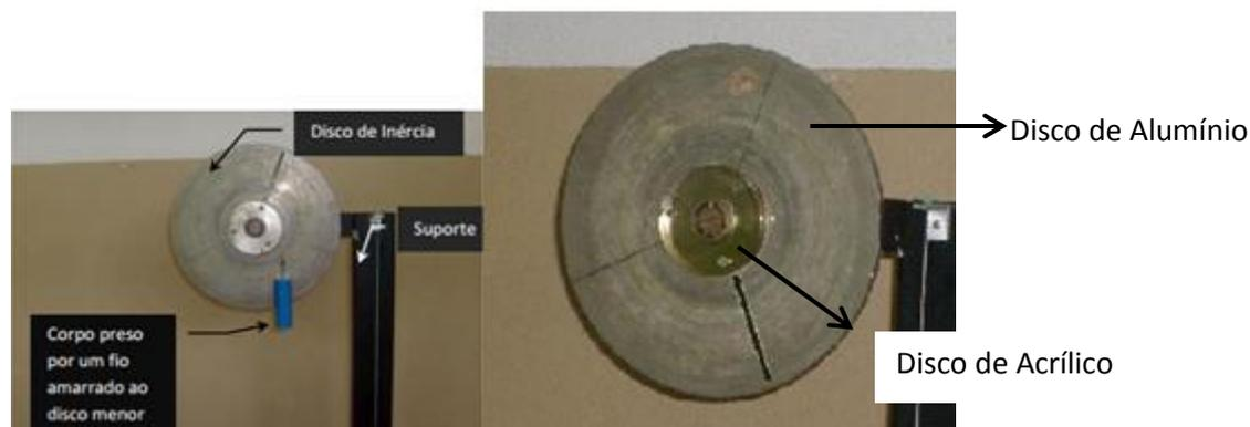
**FIGURA 1:** Roda de Inércia usada no experimento
