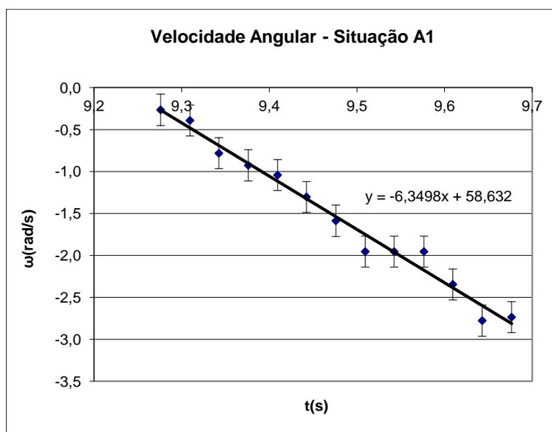
**FIGURA 3:** Gráfico construído para obtenção da aceleração angular.
