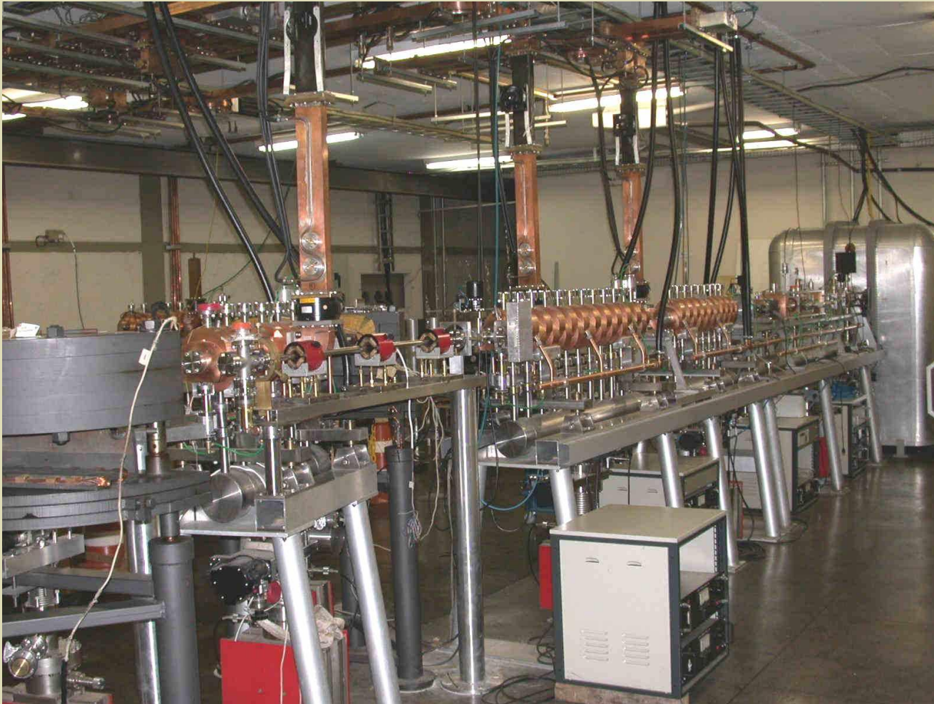
Acelerador de electrones con microondas. Líneas de irradiación con: 100 keV, 1.9 y 5 MeV
