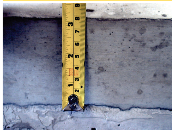
Figura 8 - Aspecto do substrato tracionado após a remoldagem e após a colagem do reforço externo
