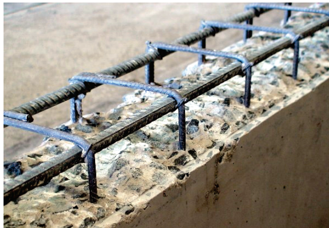
Figura 7 - Remoção do concreto do banzo tracionado da viga V2C
