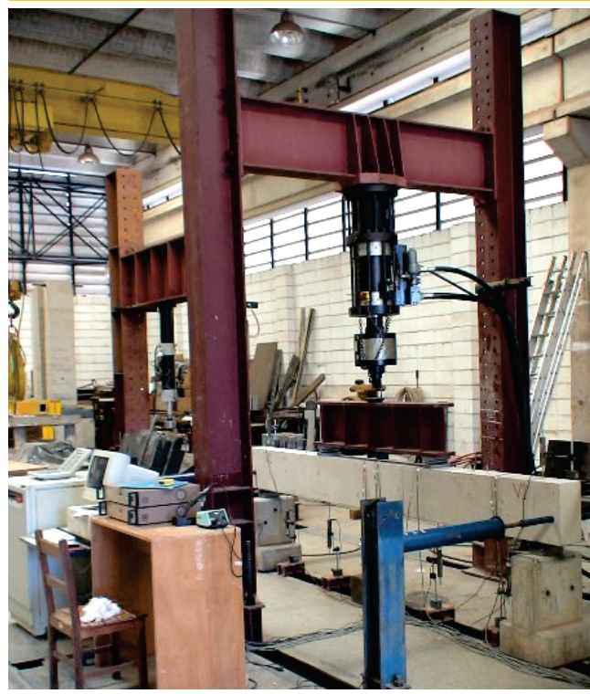
Figura 9 – Esquema geral do ensaio de flexão das vigas
