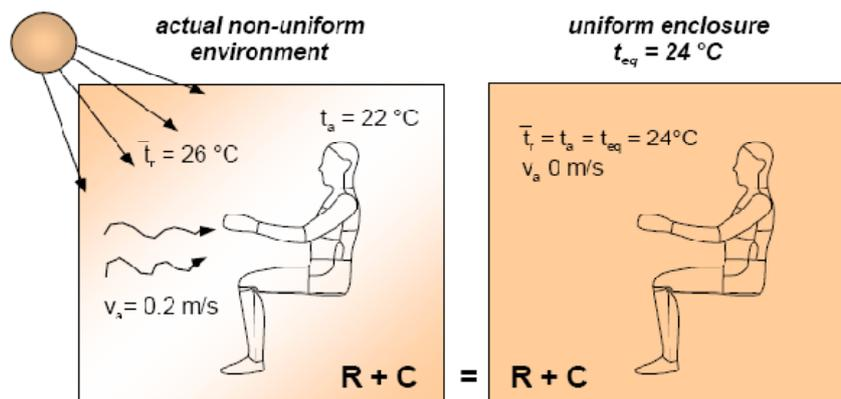
Figura 4 - Ilustração da definição de temperatura equivalente aplicada aos diversos segmentos do corpo
