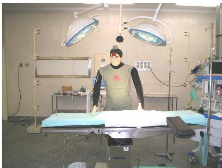
Figura 7 - Manequim posicionado na sala cirúrgica do Ensaio B, Tabela 1, simulando o cirurgião
