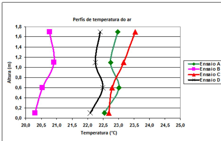
Figura 8 - Perfis de temperatura do ar
