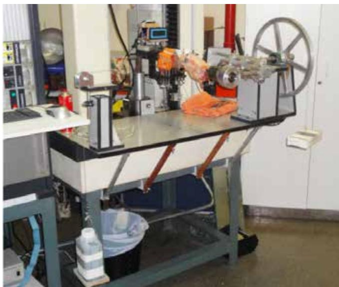
**Figura 3** – Joelho direito fixado ao dispositivo mecânico, evidenciando o peso acoplado à polia (à direita) e o peso utilizado para lateralizar a patela (à esquerda).
