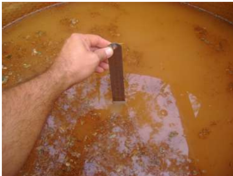
FIGURA 2. Leitura da lâmina escoada. Measurement of runoff depth.
