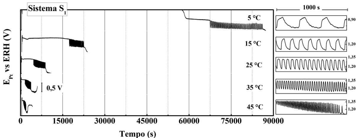
**Figura 1.** Evolução temporal do potencial do eletrodo de platina no sistema  $S_1$  em todas as temperaturas estudadas. À direita são mostrados alguns detalhes das séries temporais para um mesmo intervalo de tempo e diferentes temperaturas
