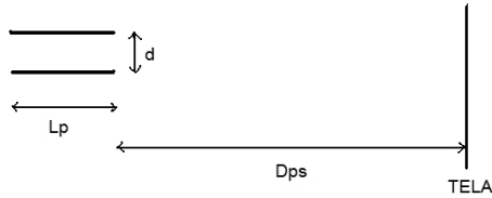
Figura 6 - Esquema utilizado para o desenvolvimento do modelo com placas equivalentes.
