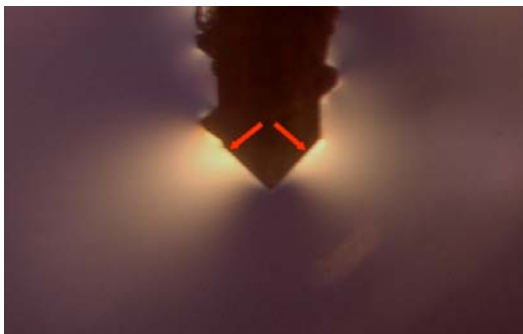
Figura 6: Tensões produzidas após aplicação de torção de inserção pelo mini-implante cilíndrico.
