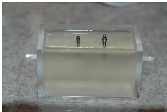
Figura 2: Modelo fotoelástico, com os 2 mini-implantes suspensos no material fotoelástico.
