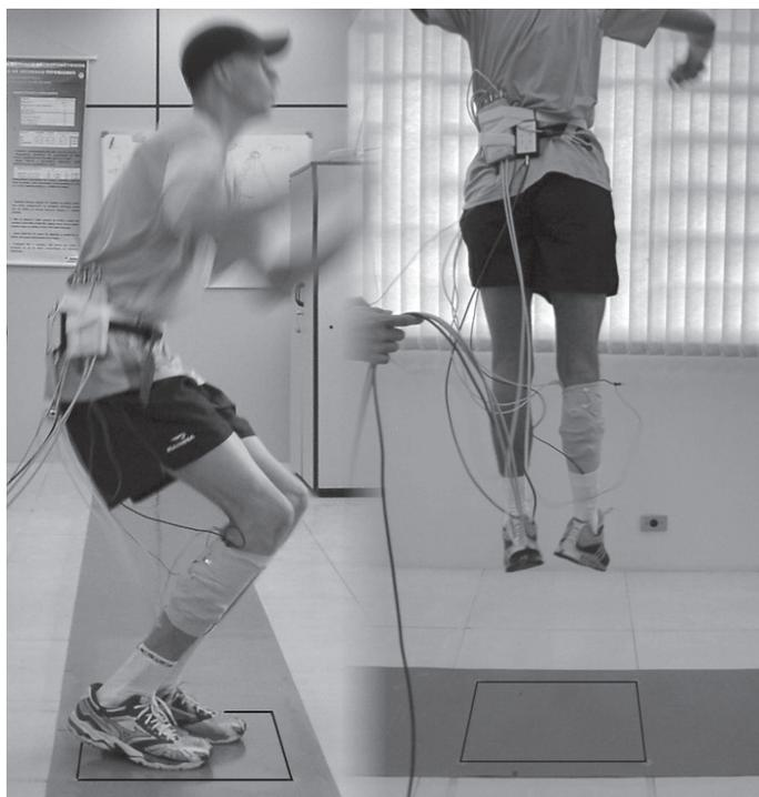
**Figura 1.** Indivíduo executando o movimento de bloqueio sobre a plataforma de força: realizando a impulsão (à esquerda) e na fase aérea (à direita); o quadrado no solo ilustra a área delimitada pela plataforma de força.
