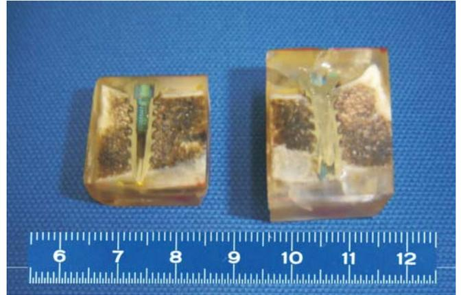
**Figura 3** – Fotografia da vértebra após a sua inclusão na resina e secção. Observar os parafusos no seu interior.
