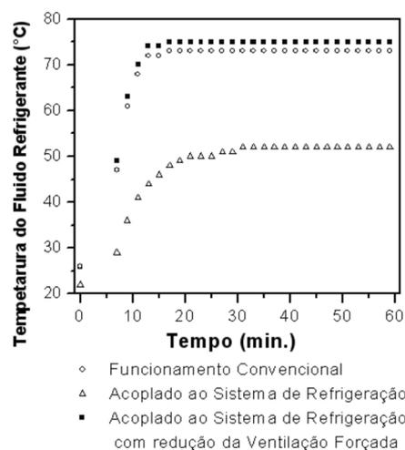
Figura 5. Evolução temporal da temperatura do fluido refrigerante
