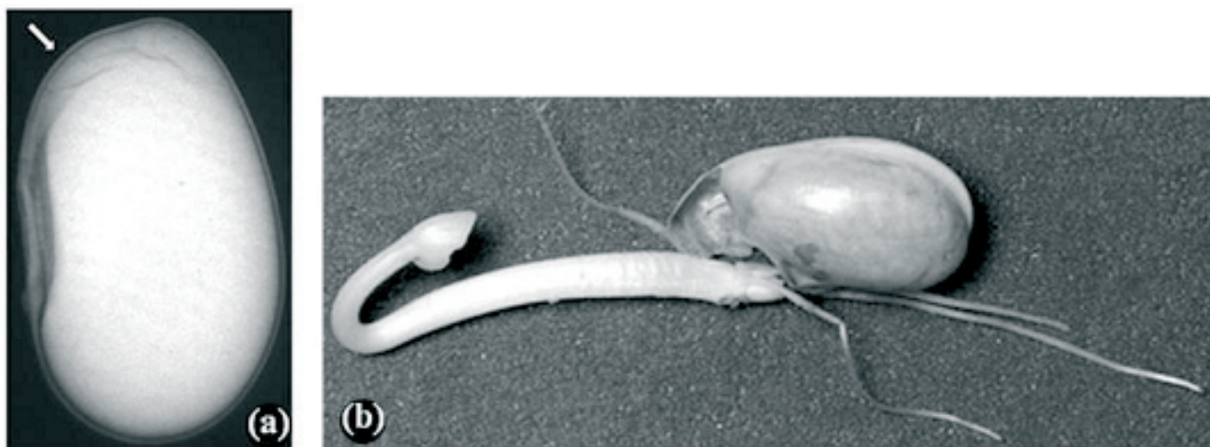
FIGURA 5. Semente submetida a cinco impactos a 551,6KPa, resultando em dano mecânico severo no eixo embrionário; imagem de raios X (a) e fotografia da plântula anormal resultante (b).
