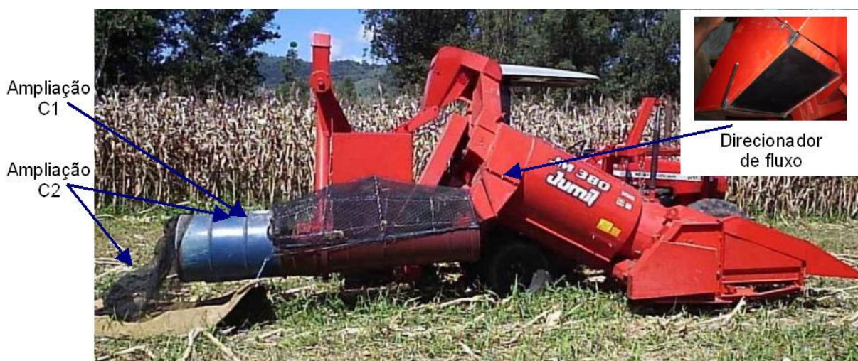
FIGURA 1. Vista lateral do reservatório de palha da colhedora C2 com detalhes do direcionador de fluxo e das ampliações para as colhedoras C1 e C2. Lateral view of the straw compartment of C2 harvester with details of the flow guiding and the enlargements for the harvester C1 and C2.
