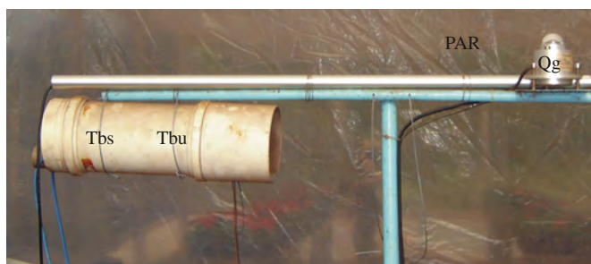
Figura 2. Instrumentos meteorológicos instalados em cada tratamento: radiação solar global (Qg), radiação fotossinteticamente ativa (PAR), temperatura de bulbo seco (Tbs) e temperatura de bulbo úmido (psicrômetro ventilado)
