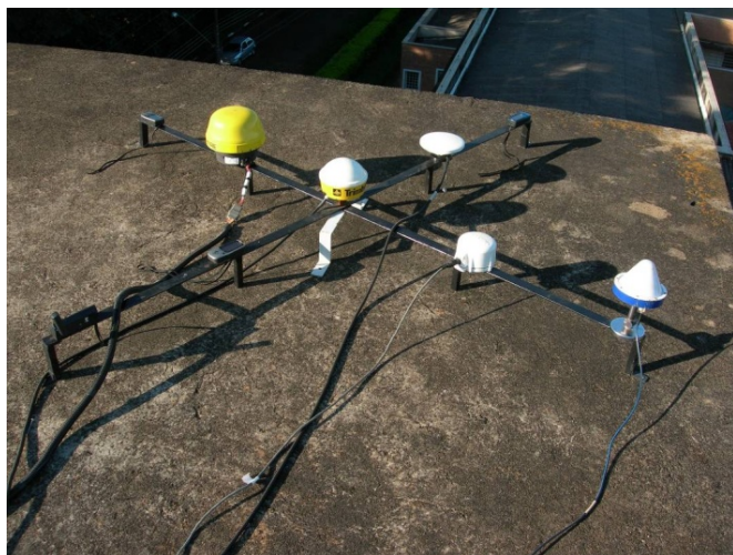
Figura 1. Receptores utilizados no ensaio dispostos sobre a estrutura em cruz acima de uma torre
