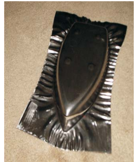
Figura 9 - Peça exemplo estampada com aço inoxidável AISI 430-E2.
