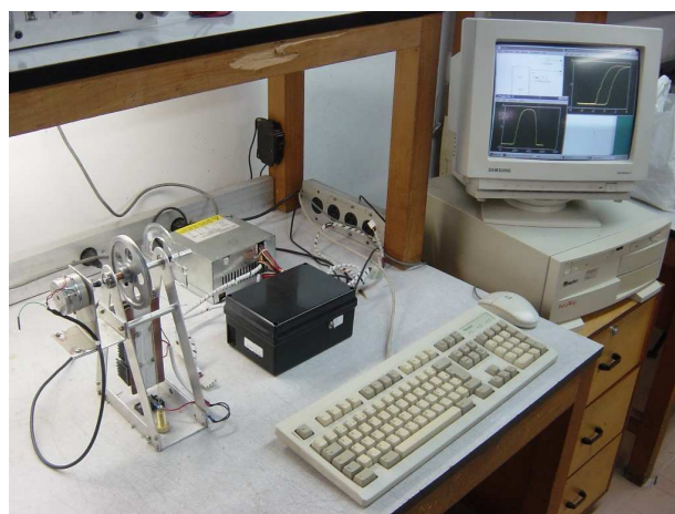
Figura 7: Atuador SMA interligado ao circuito amplificador e microcomputador
