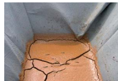
Lodo de Sulfato de alumínio - ST= 13%
