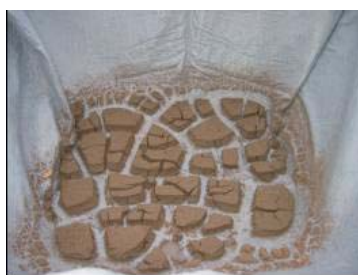
Lodo de Sulfato de alumínio - ST=31%
